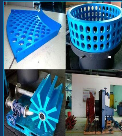
REVESTIMIENTO CELDA DE FLOTACION
